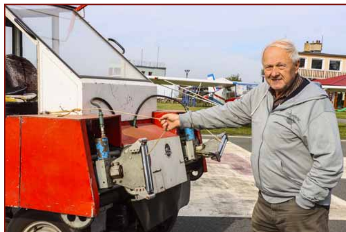
▲ Jan Starý z přibyslavského Aeroklubu ukazuje naviják, s jehož pomocí dříve v Přibyslavi vzlétaly větrně
